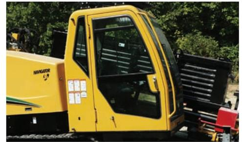
**MEHR KOMFORT.** Zusätzlichen Komfort bietet die Klimaanlage der wetterfesten Kabine sowie ein reduzierter Geräuschpegel von nur 80 dB(a) am Ohr des Bedieners.
