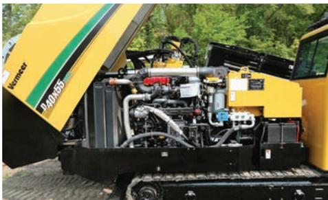
**BEEINDRUCKENDE LEISTUNG.** Ausgestattet mit einem 104 kW (140 PS) John Deere Diesel Motor liefert die D40x55DR S3 eine Vorschub-/Rückzugskraft von 177,9 kN sowie ein max. Drehmoment von 7.457 Nm.
