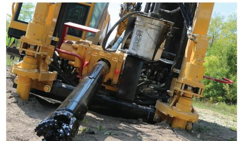
**WENIGER EINSCHRÄNKUNGEN.** Da der Bentonitfluss durch die Innen- und Außenstange geleitet wird, ergeben sich mehr Möglichkeiten bei der Werkzeugwahl. Somit steht mehr Spülungs- oder Luftvolumen für den Einsatz mittels Felsbohrkopf, Lufthammer oder Aufweitwerkzeug zur Verfügung.
